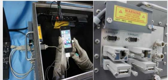
シールドボックス側面に搭載されているコネクタパネルを経由してUSBケーブルを引き込むことができます。
