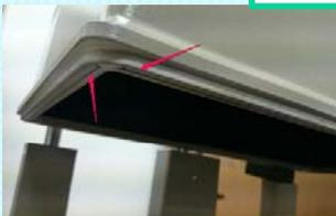
シールドガスケットを交換するだけで、納品時とほぼ同じ性能に戻すことができます。定期的な『メンテナンス』と『パーツ交換』は、シールド性能を維持するための必要な作業です。1年に1度、或いは開閉動作10万回を目安に、シールドガスケットの交換をお勧めします。
